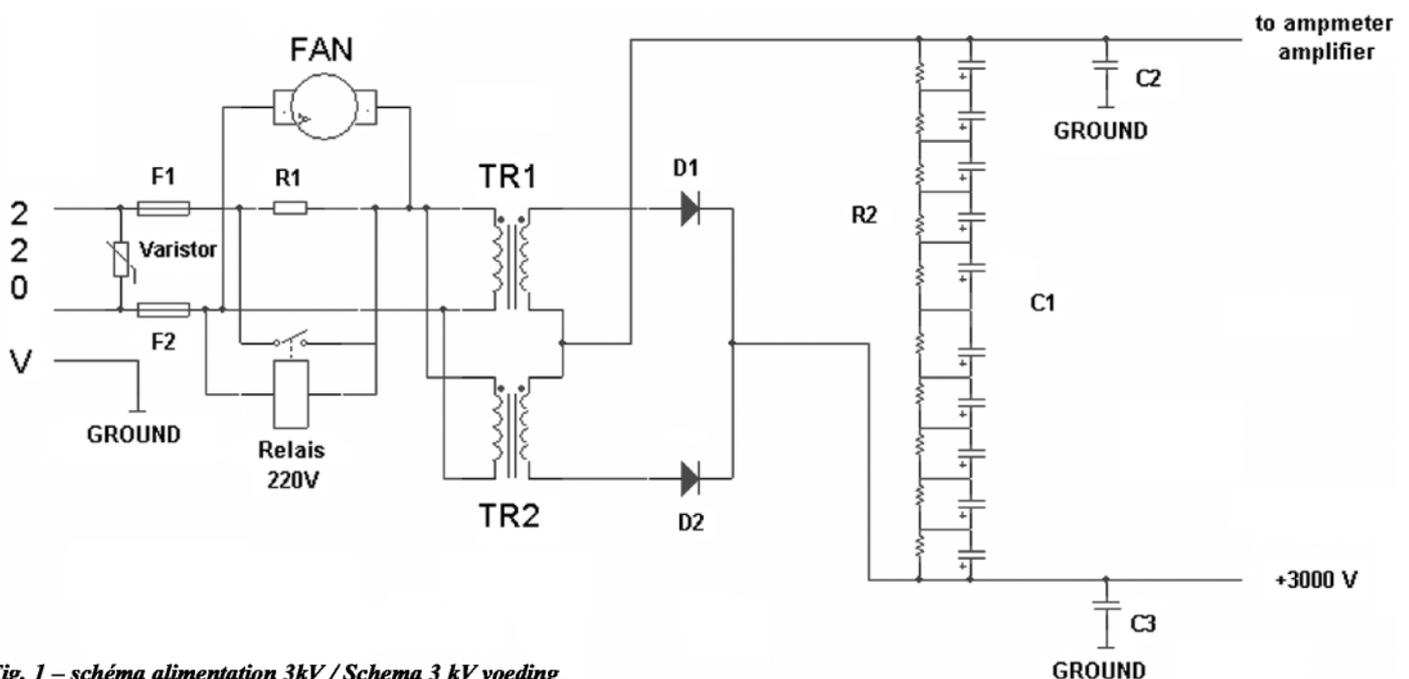
Fig. 1 – schéma alimentation 3kV / Schema 3 kV voeding
